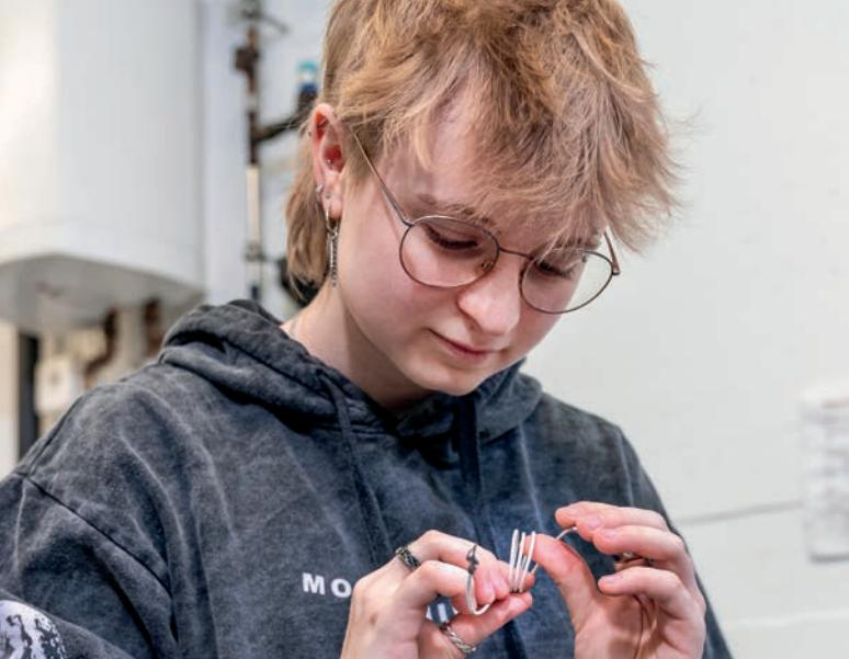
Après un test sur la machine d'enroulement, l'apprentie vérifie qu'il n'y a pas de déchirures sur le câble.
