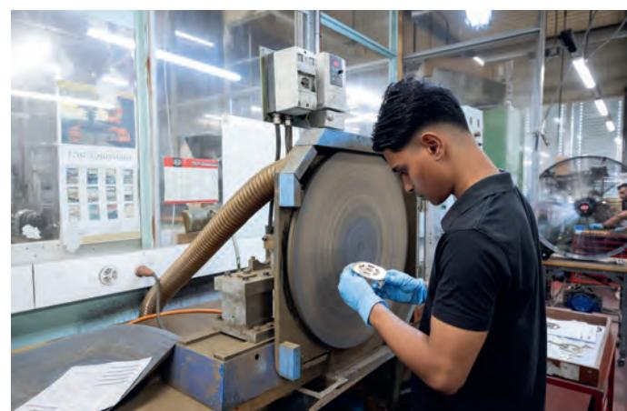
▲ **Sablage** Pour se protéger des jets de matière, le sablage des pièces se fait en insérant les mains dans la machine.
