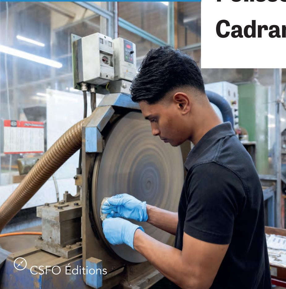
La dernière touche apportée au lustre des montres, pendules ou autres bijoux passe par les mains expertes des polisseurs et des termineurs en habillage horloger. Ces professionnels enlèvent les traces d'usinage et préparent la surface des pièces fabriquées dans les ateliers de micro-technique pour leur donner leur aspect final, brillant ou satiné. Les cadranographes, quant à eux, donnent vie aux cadrants des montres par différentes techniques comme la décalque ou la sérigraphie.
