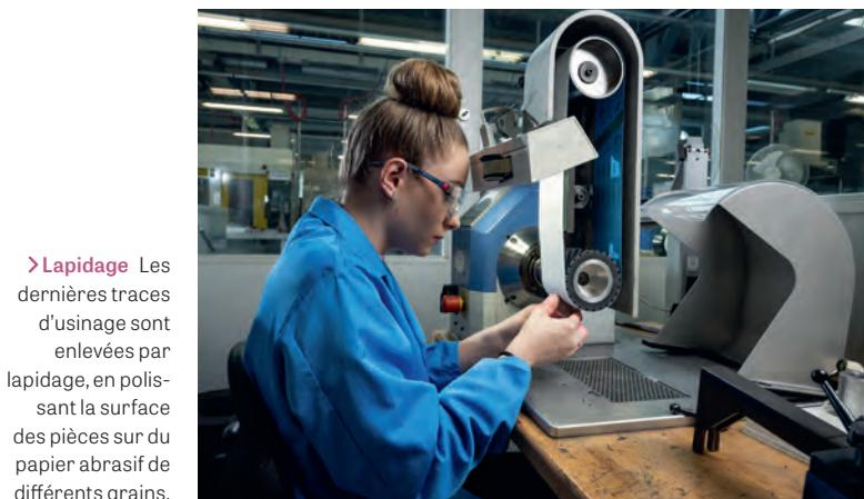
► **Lapidage** Les dernières traces d'usinage sont enlevées par lapidage, en polissant la surface des pièces sur du papier abrasif de différents grains.
