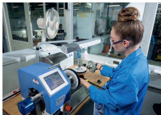
▲ **Préparation** Les termineurs et les polisseurs installent différents disques de polissage sur leur machine.
