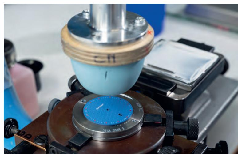
▲ **Tampographie** Le tampon en silicone imprégné de vernis dépose la décalque sur le cadran.
