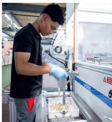
► **Lavage** Les pièces sont passées dans différents bains d'eau chaude, parfois dans des machines automatisées, afin d'enlever les dernières traces de graisse.
