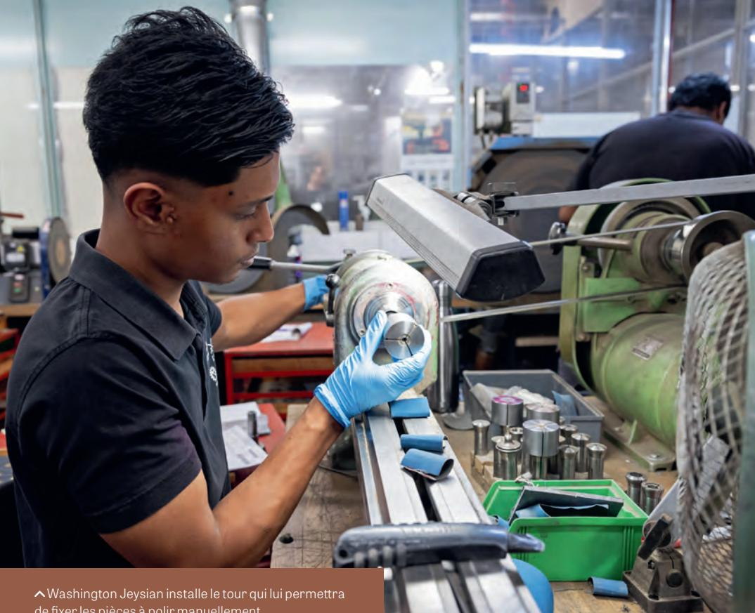
▲Washington Jeyisan installe le tour qui lui permettra de fixer les pièces à polir manuellement.
