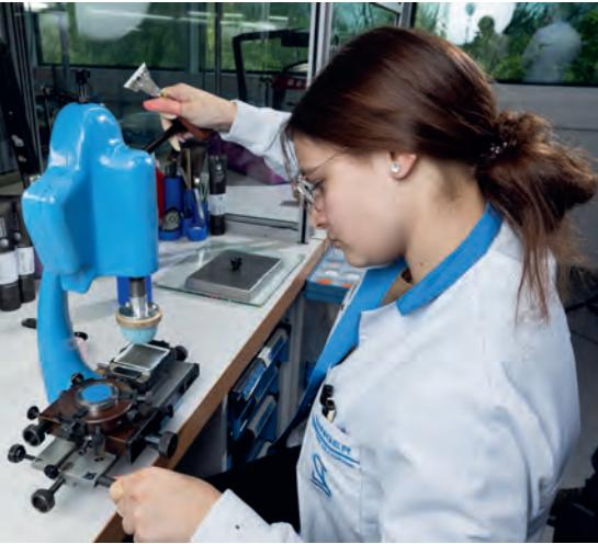
▲ La machine est actionnée manuellement pour que le tampon vienne chercher le vernis sur le cliché puis le déposer sur le cadran.
