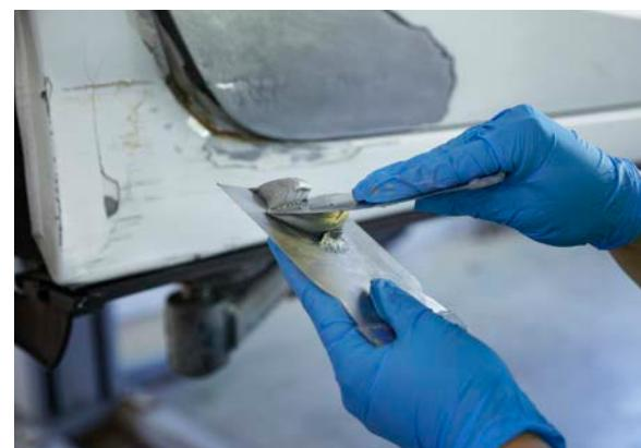
↖ Schleifen und Spachteln Die beschädigte Stelle wird in mehreren Schritten geschliffen und mit Spachtelmasse gefüllt. So ist später kein Unterschied mehr zu erkennen.
