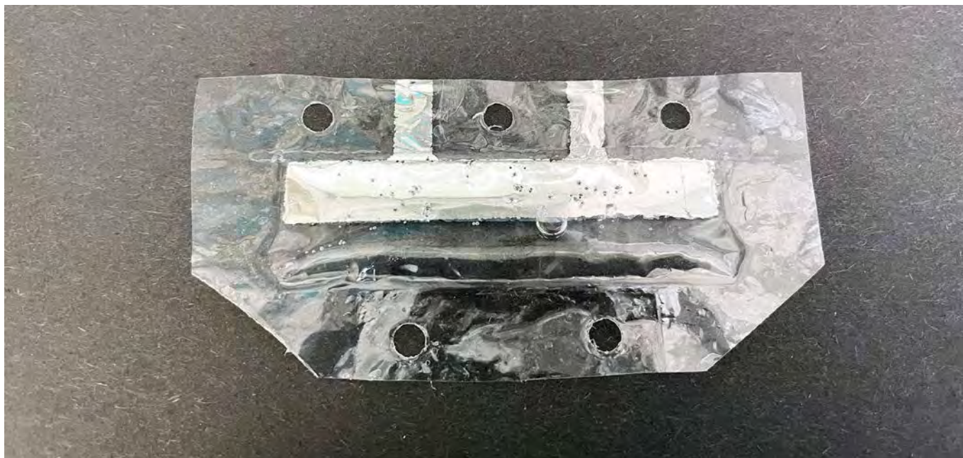
Vergrösserte Ansicht: Aktuator in durchsichtiger Hülle. Auch mit über 30 Durchschlagslöchern war der neue Halve-Aktuator immer noch voll funktionsfähig.
