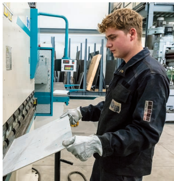
✓ Pour façonner les pièces, Jordan Iametti utilise différentes techniques, telles que le pliage.
