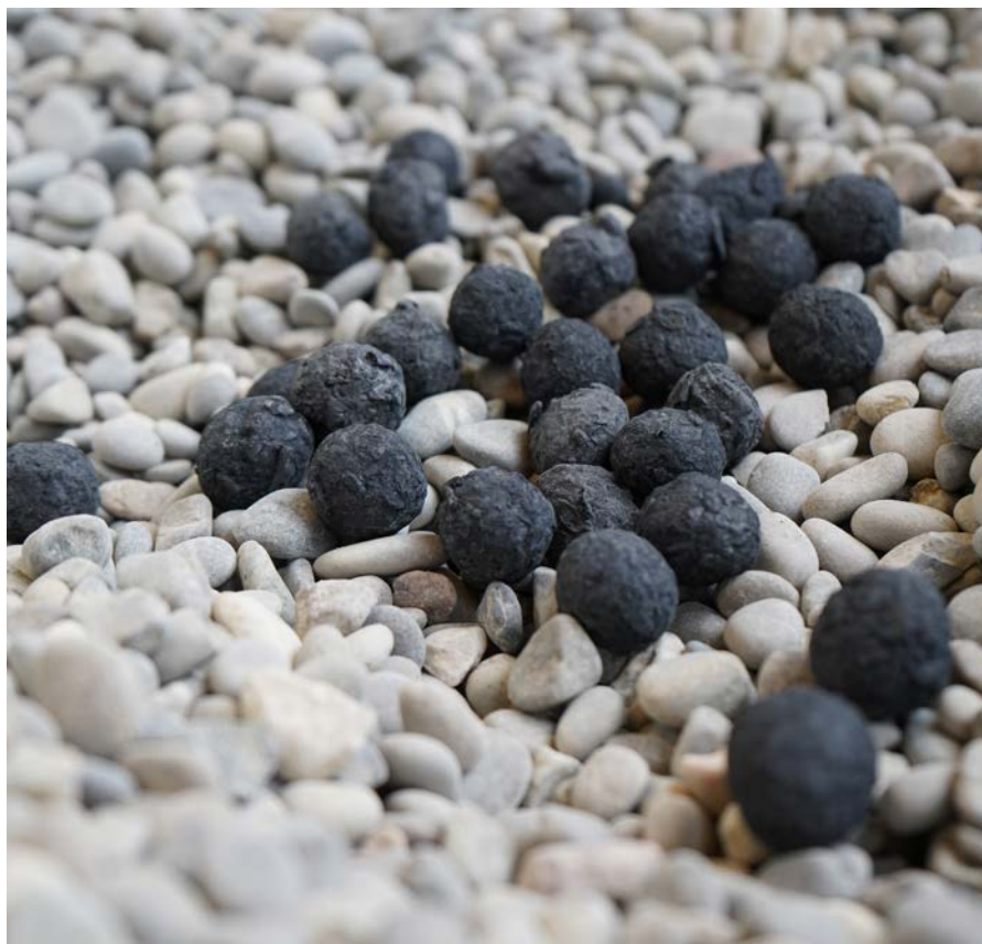
20 Volumenprozent Kohlenstoff-Pellets (schwarz) resultieren in Beton mit Netto-Null-Emissionen.
