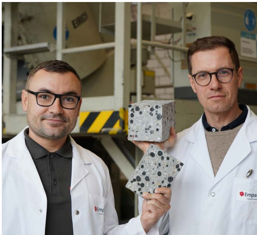
Beton ohne Emissionen: Empa-Forscher Mateusz Wyrzykowski (rechts) und Nikolajs Toropovs ersetzen herkömmliche Gesteinskörnungen durch Pellets aus Pflanzenkohle.
