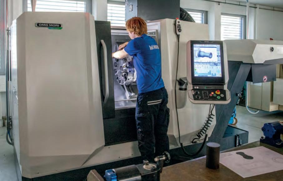
◀ Avant de lancer la production, Antanas Balciunas fixe les outils d'usinage sur la machine CNC, puis la programme.
