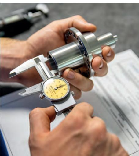
**> Mesurer et contrôler les pièces** Une fois produites, les pièces sont mesurées précisément et comparées aux plans de fabrication. Les résultats de ces vérifications sont consignés.
