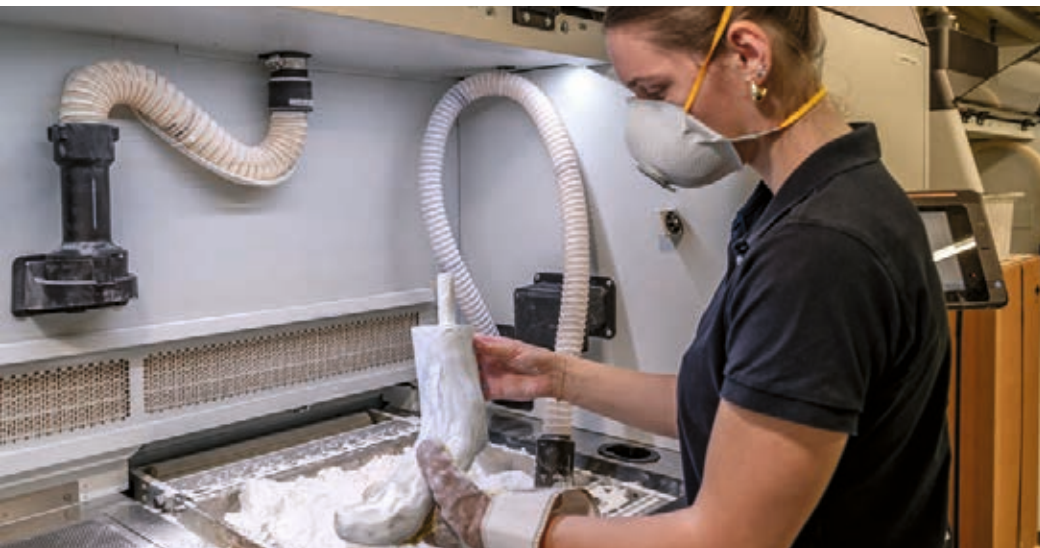
↗ Die Lernende entfernt sorgfältig den Kunststoffstaub vom frisch gedruckten Teil einer Prothese.
