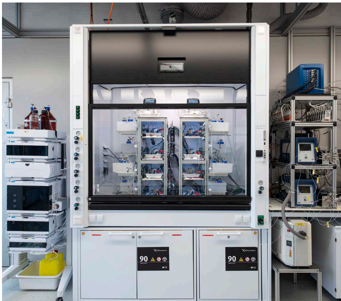
Zehn Experimente parallel: Die neue Anlage der Empa kann die Forschung zur CO 2 -Elektrolyse bis zu zehnmals beschleunigen.
