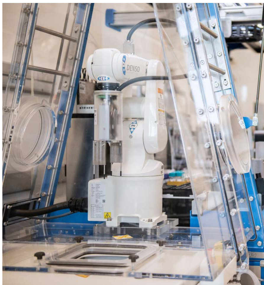
Dieser Roboterarm transferiert Glasfläschchen in eine Zentrifuge. Er ist Teil einer Robotereinheit, die Katalysatoren vollständig autonom nach den Vorgaben von Berechnungen eines AI-Modells herstellt.
