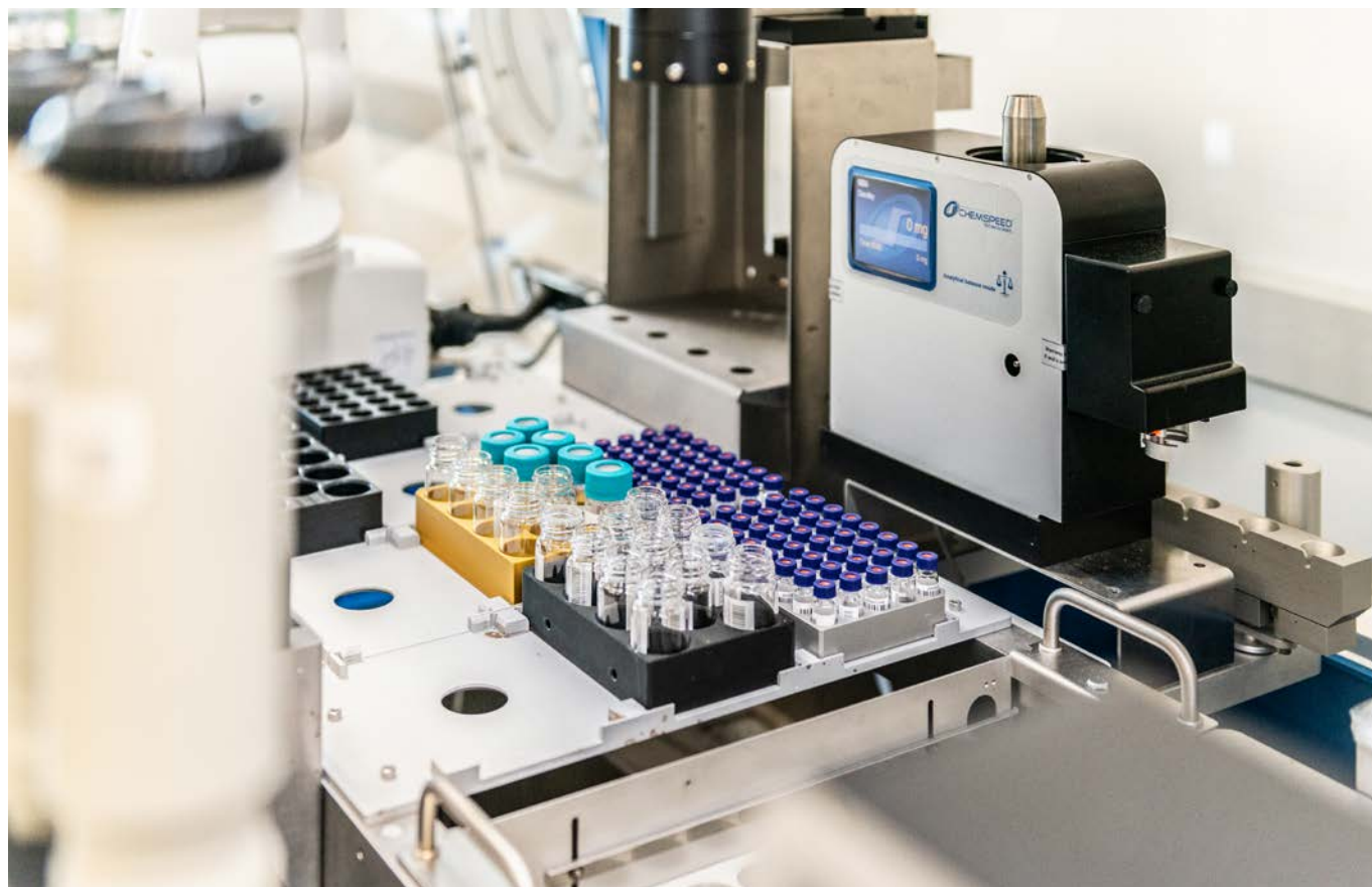
Präzisionswaage des Robotersystems. Das System transferiert feste und flüssige Ausgangschemikalien in die Glasfläschchen, in denen die Synthese stattfindet.
