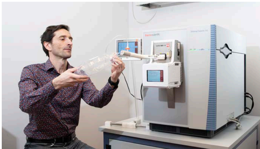
Pablo Sinues analysiert eine Atemluftprobe aus einem Probeentnahmebeutel. Das hochauflösende Massenspektrometer liefert Ergebnisse in nur 30 Sekunden.
