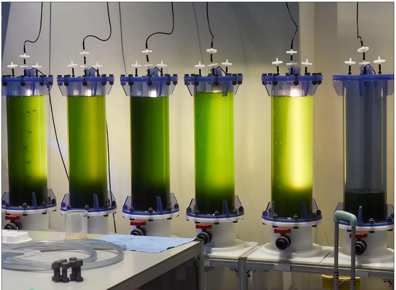
Bioreaktoren mit grüner Flüssigkeit für die Algenkultivierung. Algen können u. a. als Nahrungs-/Futtermittel oder biologische Treibstoffe verwendet werden.
