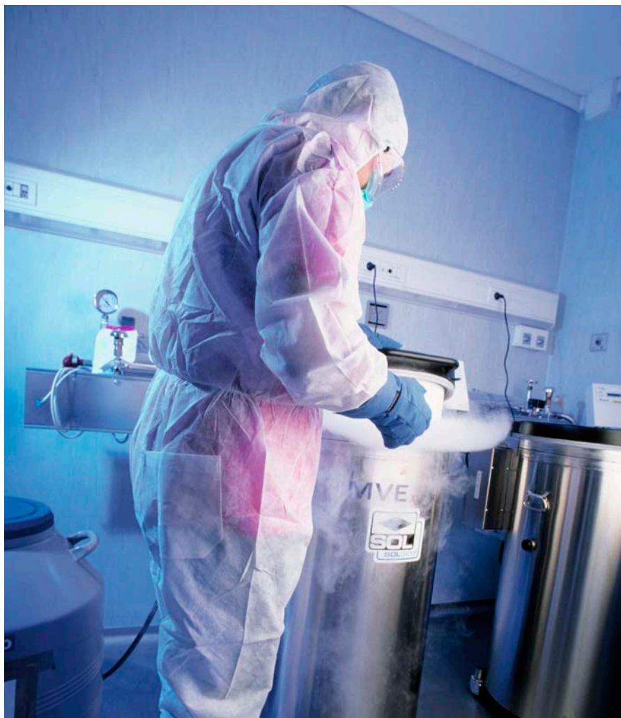
Forscher bei der Entnahme von Stammzellen aus der Kryolagerung. Die Stammzellen wurden in flüssigem Stickstoff gelagert, um sie zu konservieren.
