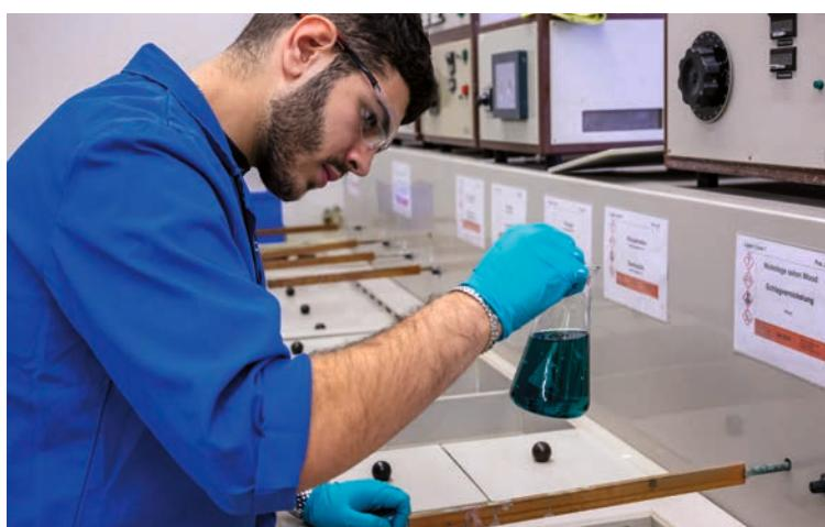
**▲ Entretenir les électrolytes** Selon la fréquence d'utilisation des électrolytes, il faut régulièrement prélever des échantillons afin de contrôler la quantité de métal contenue dans les bains.
