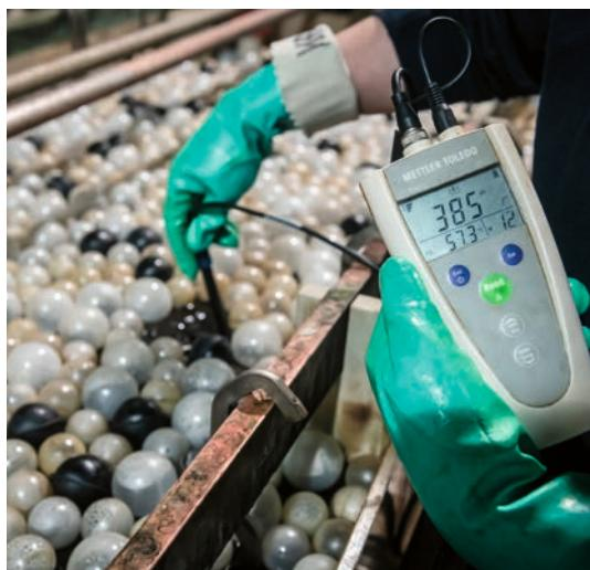
**◀ Surveiller les bains** Pendant le traitement, les électroplastiques contrôlent le pH ainsi que la température de l'eau.
