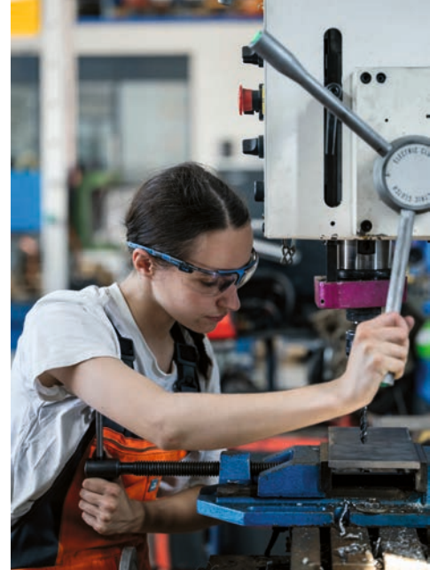
▲ Clara è intenta a forare una piastra d'acciaio per adattarla a una macchina.
