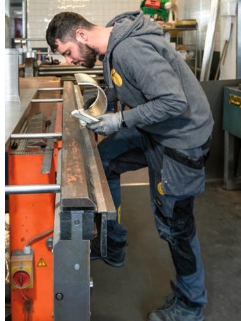
➤ Pour fabriquer un tuyau, Andrea Piceci forme la pièce en tôle à l'aide d'une machine de cintrage.
