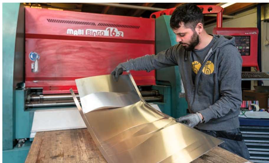
✓ Le calorifugeur-tôlier retire les morceaux de tôle inutiles de la pièce découpée par la machine à commande numérique.
