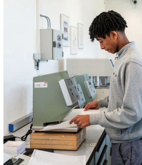
Im Labor prüft der angehende Papiertechnologe, ob die Qualität des Papiers den Anforderungen entspricht.
