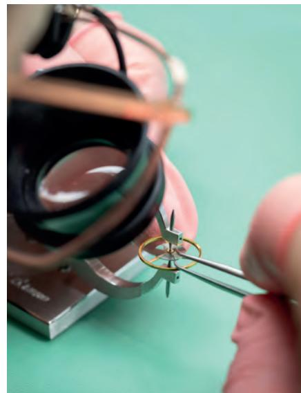
**◀ Spiraler** Les horlogers doivent adapter la longueur et la forme du petit ressort appelé spiral pour assurer la précision du mouvement de la montre.
