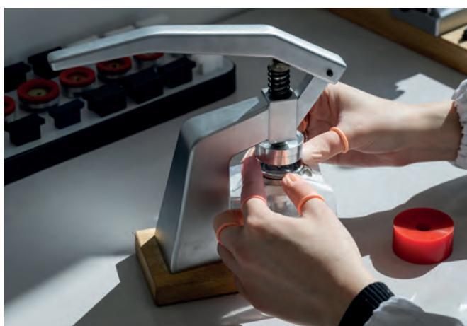
**▲ Emboîter et habiller** Le mouvement est placé dans la boîte de la montre. Les composants visibles (boîte, cadran, aiguilles, poussoir, etc.) « habillent » ensuite le mouvement. Ils sont parfois intégrés à l'aide d'une presse.
