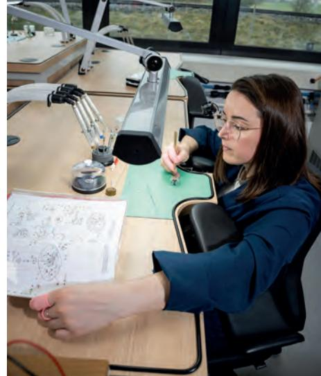
**◀ Assembler** Des plans techniques, par exemple l'éclaté du mouvement de la montre, sont d'une précieuse aide. Ils indiquent l'ordre à suivre pour intégrer chaque composant.
