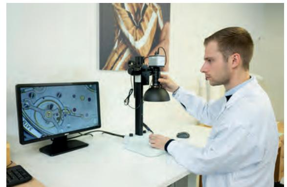
**▲ Reporter les défauts** Lorsqu'un défaut est constaté, des photos peuvent être prises grâce à un microscope électronique et envoyées avec un rapport au contrôle qualité.
