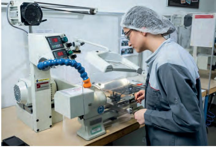
**▲ Usiner** Les horlogers acquièrent des bases en micromécanique et fabriquent leurs propres outils, par exemple au tour automatique ou à la fraiseuse. Les finitions sont notamment réalisées à la lime.
