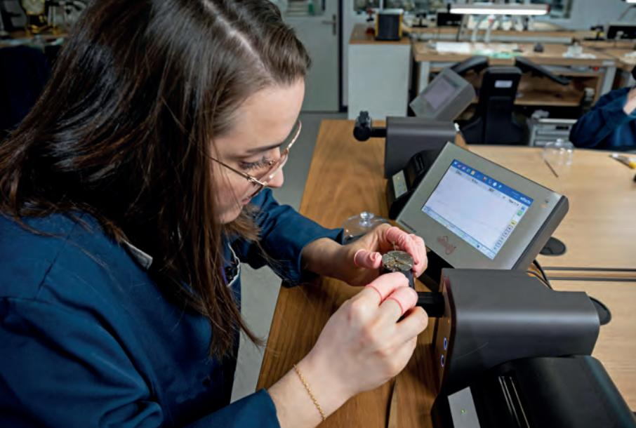
◀ Léa Bruno contrôle la précision du mouvement à l'aide d'une machine qui mesure les bruits du battement. Des ajustements doivent être apportés si la courbe à l'écran n'est pas assez plate.
