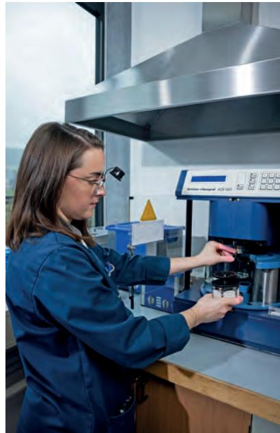
**▼ Nettoyer** Les composants de la montre doivent être parfaitement propres. Au besoin, ils sont placés dans un panier et mis dans une machine qui les passe dans différents bains chimiques.
