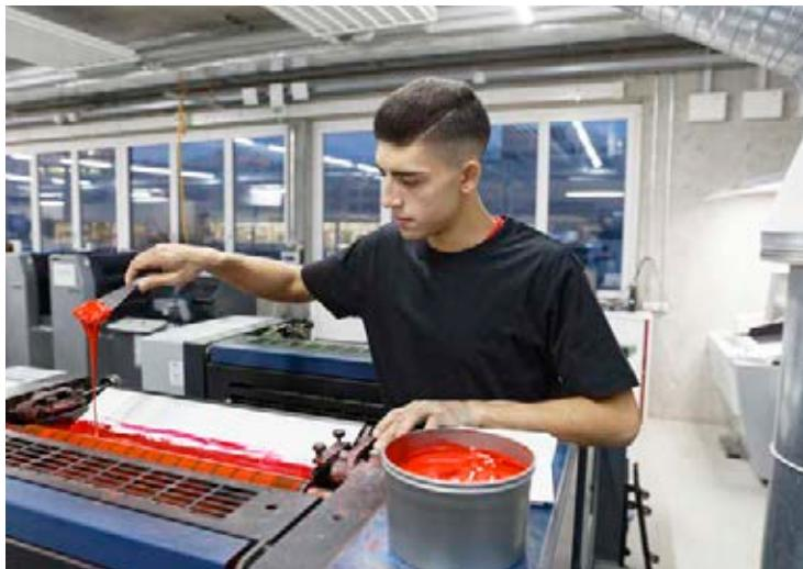
**▲ Recharger les enciers** Les technologues en médias remplissent les enciers de la presse offset. Ils règlent leur écoulement et impriment une page test.
