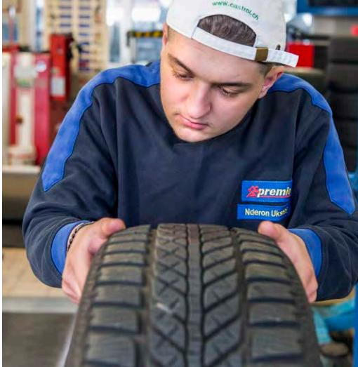
▲ Contrôler les pneus Pour une conduite sûre, il faut des pneus en bon état. Les praticiens en pneumatiques examinent les pneus avant le montage et s'assurent qu'ils n'ont pas subi de dommages.
