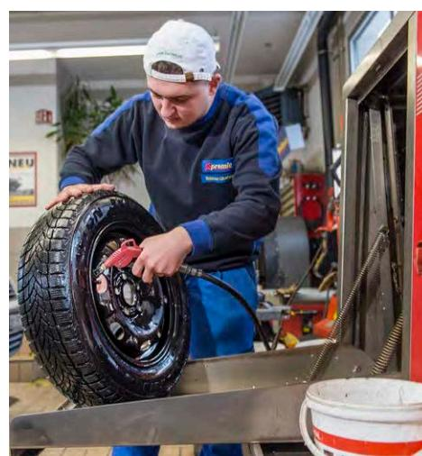
◀ Gonfler les pneus et nettoyer les roues Les jantes doivent briller et les pneus être gonflés à la bonne pression. Pour les pneus de poids lourds, cette dernière opération est effectuée dans une cage de gonflage, qui protège contre les projections au cas où un pneu viendrait à éclater.
