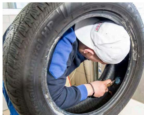
◀ Réparer les pneus Entailles, fissures, les praticiens en pneumatiques savent réparer toutes sortes de dégâts sur les pneus.
