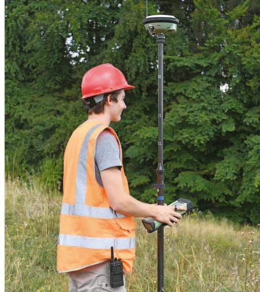
**> Misurazioni satellitari** Grazie al GNSS è diventato molto più facile fare misurazioni precise. Anche i droni vengono utilizzati sempre più spesso, soprattutto per le immagini aeree.
