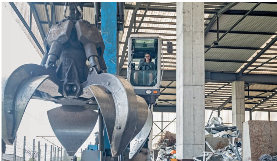
▲ La recycleuse utilise une grue munie d'un grappin pour déverser la ferraille dans un wagon de chemin de fer.
