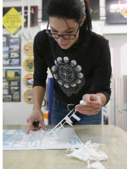
➤ Le dépouillage consiste à retirer le surplus de matière autour des lettres ou d'un logo.
